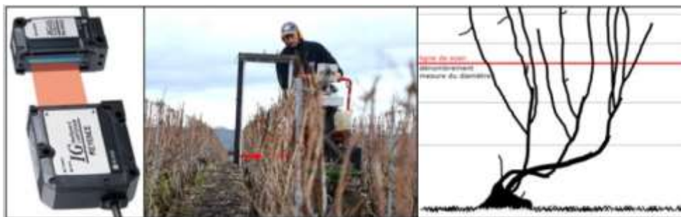
Figure 1 : capteur, montage sur chenillard et mesure sur taille chablis en Champagne.
