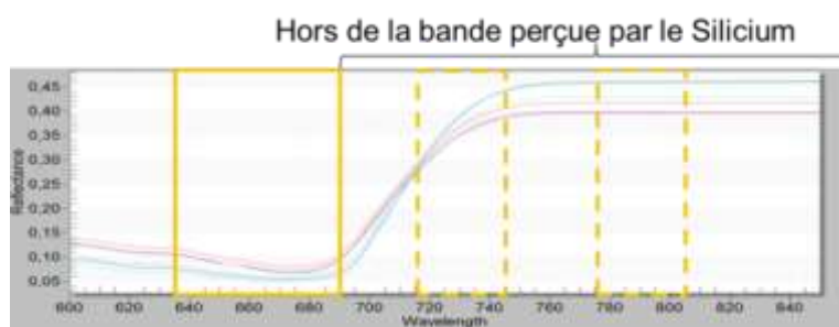
Figure 5 : Spectres de feuilles de vigne infestées et saines dans la gamme spectrale 600 nm-850 nm
