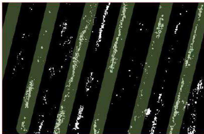
Figure 2 : Association des rangs de vigne (en vert) et des pixels ayant une élévation relative supérieure à 25 cm en blanc.
